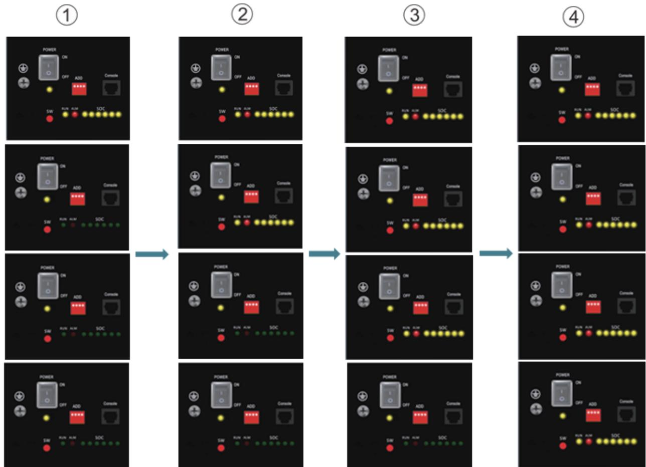
Si todos los LED de la batería se encienden y luego se apagan, significa que el sistema de la batería está bien y funcionando.
